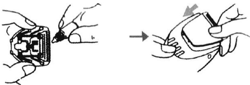
5. После очистки нанесите немного смазочного масла на лезвие, затем установите лезвие на место. Вы услышите щелчок, подтверждающий, что лезвие успешно установлено.
